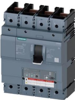
Interruttore automatico 3VA6 UL Frame 400 Classe del potere di interruzione M 35kA @ 480V a 4 poli, protezione impianto ETU320, LI, In=250A protezione da sovraccarico Ir=100A...250A protezione da cortocircuito Ii=1,5...12 x In protezione del conduttore di neutro impostabile (OFF, 50%, 100%) senza collegamento
