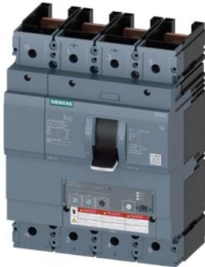
interruttore automatico 3VA6 UL Frame 400 classe del potere di interruzione E 200 kA @ 480 V a 4 poli, protezione impianto ETU320, LI, In=250 A protezione da sovraccarico Ir=100 A ... 250 A protezione da cortocircuito Ii=1,5 ... 12 x In protezione del conduttore di neutro impostabile (OFF, 50 %, 100 %) senza collegamento
