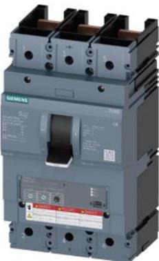
interruttore automatico 3VA6 UL Frame 400 classe del potere di interruzione E 200 kA @ 480 V a 3 poli, protezione impianto ETU320, LI, In=250 A protezione da sovraccarico Ir=100 A ... 250 A protezione da cortocircuito Ii=1,5 ... 12 x In senza collegamento
