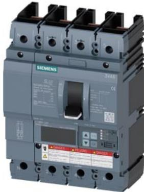
Interruttore automatico 3VA6 UL Frame 250 Classe del potere di interruzione L 150kA @ 480 V a 4 poli, protezione impianto ETU860, LSIG,  $I_n=250A$  protezione da sovraccarico  $I_r=100A...250A$  protezione da cortocircuito  $I_{sd}=0,6..10x I_n$ ,  $I_i=1,5..10x I_n$  protezione del conduttore di neutro impostabile (OFF, fino a 100%) protezione da guasto verso terra  $I_g=0,2...1 x I_n= tg=0,05-0,8s$  senza collegamento
