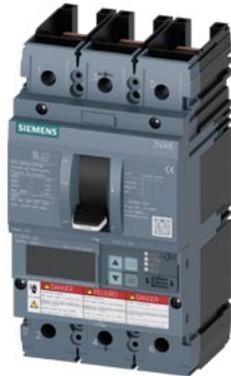
interruttore automatico 3VA6 UL frame 250 classe del potere di interruzione L 150 kA con 480 V a 3 poli, protezione impianto ETU830, LIG,  $I_n=250$  A protezione da sovraccarico, 100 % nominale  $I_r=100$  A ... 250 A protezione da cortocircuito  $i_i=1,5$  ...  $10 \times I_n$  protezione da guasto verso terra  $I_g=0,2$  ...  $1 \times I_n$ ,  $t_g=0,05$ ...0,8s senza collegamento
