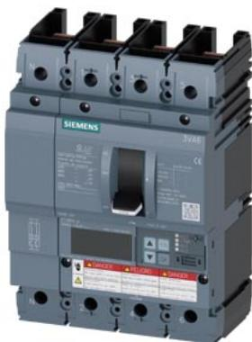
Interruttore automatico 3VA6 UL Frame 250 Classe del potere di interruzione L 150kA @ 480 V a 4 poli, protezione impianto ETU820, LI, In=250A protezione da sovraccarico Ir=100A...250A protezione da cortocircuito Ii=1,5...10 x In senza collegamento
