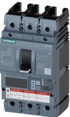
interruttore automatico 3VA6 UL frame 250 classe del potere di interruzione L 150 kA con 480 V a 3 poli, protezione impianto ETU820, LI, In=250 A protezione da sovraccarico, 100 % nominale Ir=100 A ... 250 A protezione da cortocircuito Ii=1,5 ... 10 x In senza collegamento
