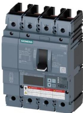
Interruttore automatico 3VA6 UL Frame 250 Classe del potere di interruzione L 150kA @ 480 V a 4 poli, protezione impianto ETU560, LSIG, In=250A protezione da sovraccarico Ir=100A...250A protezione da cortocircuito Isd=0,6..10x In, Ii=1,5..10x In protezione del conduttore di neutro impostabile (OFF, fino a 100%) protezione da guasto verso terra Ig=0,2...1 x In= tg=0,05-0,8s senza collegamento
