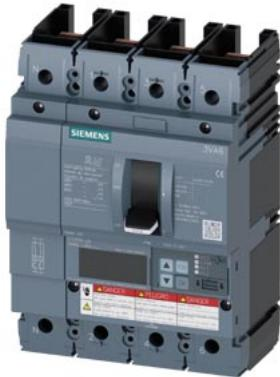
Interruttore automatico 3VA6 UL Frame 250 Classe del potere di interruzione L 150kA @ 480 V a 4 poli, protezione impianto ETU550, LSI, In=250A protezione da sovraccarico Ir=100A...250A protezione da cortocircuito Isd=0,6..10x In, li=1,5..10x In protezione del conduttore di neutro impostabile (OFF, fino a 100%) senza collegamento
