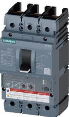
interruttore automatico 3VA6 UL frame 250 classe del potere di interruzione C 100 kA con 480V a 3 poli, protezione impianto ETU330, LIG, In=250 A protezione da sovraccarico, 100 % nominale Ir=100 A ... 250 A protezione da cortocircuito Ii=1,5 ... 10 x In protezione da guasto verso terra Ig=0,2 ... 1 x In, tg=0,1/0,3s senza collegamento
