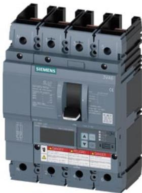
Interruttore automatico 3VA6 UL Frame 250 Classe del potere di interruzione H 65kA @ 480V a 4 poli, protezione impianto ETU860, LSIG, In=250A protezione da sovraccarico Ir=100A...250A protezione da cortocircuito Isd=0,6..10x In, li=1,5..10x In protezione del conduttore di neutro impostabile (OFF, fino a 100%) protezione da guasto verso terra Ig=0,2...1 x In= tg=0,05-0,8s senza collegamento
