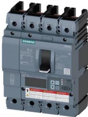
Interruttore automatico 3VA6 UL Frame 250 Classe del potere di interruzione H 65kA @ 480V a 4 poli, protezione impianto ETU550, LSI, In=250A protezione da sovraccarico Ir=100A...250A protezione da cortocircuito I<sub>sd</sub>=0,6..10x I<sub>n</sub>, I<sub>i</sub>=1,5..10x I<sub>n</sub> protezione del conduttore di neutro impostabile (OFF, fino a 100%) senza collegamento
