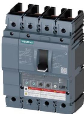
Interruttore automatico 3VA6 UL Frame 250 Classe del potere di interruzione H 65kA @ 480V a 4 poli, protezione impianto ETU330, LIG, In=250A protezione da sovraccarico Ir=100A...250A protezione da cortocircuito Ii=1,5...10 x In protezione del conduttore di neutro impostabile (OFF, 50%, 100%) protezione da guasto verso terra Ig=0,2...1 x In tg=0,1/0,3s senza collegamento
