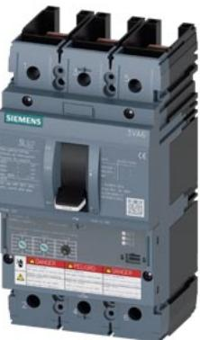
interruttore automatico 3VA6 UL frame 250 classe del potere di interruzione H 65 kA con 480V a 3 poli, protezione impianto ETU320, LI, In=250 A protezione da sovraccarico, 100 % nominale Ir=100 A ... 250 A protezione da cortocircuito Ii=1,5 ... 10 x In senza collegamento
