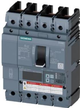
Interruttore automatico 3VA6 UL Frame 250 Classe del potere di interruzione M 35kA @ 480V a 4 poli, protezione impianto ETU856, LSI, In=250A protezione da sovraccarico Ir=100A...250A protezione da cortocircuito Isd=0,6..10x In, li=1,5..10x In protezione del conduttore di neutro impostabile (OFF, fino a 100%) allarme di guasto verso terra Segnalazione tramite EFB300 o COM senza collegamento
