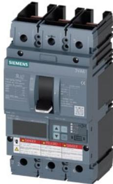
Interruttore automatico 3VA6 UL Frame 250 Classe del potere di interruzione M 35kA @ 480V a 3 poli, protezione impianto ETU830, LIG, In=250A protezione da sovraccarico Ir=100A...250A protezione da cortocircuito li=1,5...10 x In protezione da guasto verso terra Ig=0,2...1 x In, tg=0,05-0,8s senza collegamento
