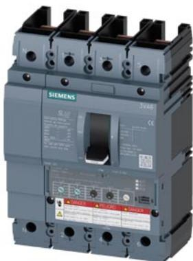
interruttore automatico 3VA6 UL frame 250 classe del potere di interruzione M 35 kA con 480V a 4 poli, protezione impianto ETU350, LSI,  $I_n=250$  A protezione da sovraccarico, 100 % nominale  $I_r=100$  A ... 250 A protezione da cortocircuito  $I_{sd}=1,5 \dots 10 \times I_r$ ,  $I_i=10 \times I_n$  protezione del conduttore di neutro regolabile (OFF, 50 %, 100 %) senza collegamento
