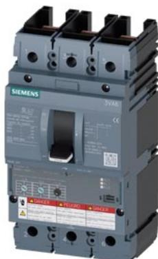
Interruttore automatico 3VA6 UL Frame 250 Classe del potere di interruzione M 35kA @ 480V a 3 poli, protezione impianto ETU320, LI, In=250A protezione da sovraccarico Ir=100A...250A protezione da cortocircuito Ii=1,5...10 x In senza collegamento
