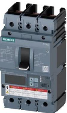
interruttore automatico 3VA6 UL Frame 250 classe del potere di interruzione E 200 kA @ 480 V a 3 poli, protezione impianto ETU856, LSI, In=250 A protezione da sovraccarico Ir=100 A ... 250 A protezione da cortocircuito Isd=0,6 ... 10 x In, Ii=1,5 ... 10x In protezione del conduttore di neutro opzionale con CT est. fino a 160 % allarme di guasto verso terra segnalazione tramite EFB300 o COM senza collegamento
