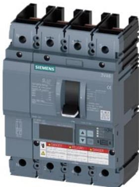
Interruttore automatico 3VA6 UL Frame 250 Classe del potere di interruzione L 150kA @ 480 V a 4 poli, protezione impianto ETU830, LIG, In=100A protezione da sovraccarico Ir=40A...100A protezione da cortocircuito Ii=1,5...12 x In protezione da guasto verso terra Ig=0,2...1 x In, tg=0,05-0,8s senza collegamento
