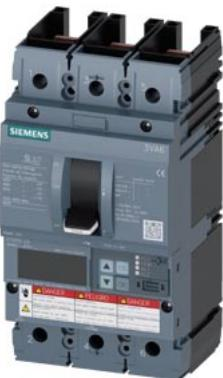
Interruttore automatico 3VA6 UL Frame 250 Classe del potere di interruzione L 150kA @ 480 V a 3 poli, protezione impianto ETU550, LSI, In=100A protezione da sovraccarico Ir=40A...100A protezione da cortocircuito I<sub>sd</sub>=0,6..10x I<sub>n</sub>, I<sub>i</sub>=1,5..12x I<sub>n</sub> protezione del conduttore di neutro opzionale con trasformatore di corrente, fino a 160% senza collegamento
