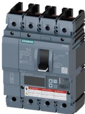
Interruttore automatico 3VA6 UL Frame 250 Classe del potere di interruzione C 100kA @ 480 V a 4 poli, protezione impianto ETU856, LSI, In=100A protezione da sovraccarico Ir=40A...100A protezione da cortocircuito Isd=0,6..10x In, Ii=1,5..12x In protezione del conduttore di neutro impostabile (OFF, fino al 160%) allarme di guasto verso terra Segnalazione tramite EFB300 o COM senza collegamento
