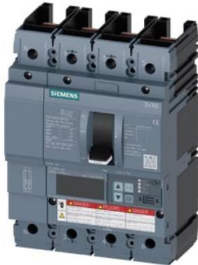
interruttore automatico 3VA6 UL frame 250 classe del potere di interruzione C 100 kA con 480V a 4 poli, protezione impianto ETU850, LSI, In=100 A protezione da sovraccarico, 100 % nominale Ir=40 A ... 100 A protezione da cortocircuito I<sub>sd</sub>=0,6 ... 10x I<sub>n</sub>, I<sub>i</sub>=1,5..12x I<sub>n</sub> protezione del conduttore di neutro regolabile (OFF, fino al 160 %) senza collegamento
