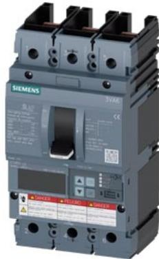
interruttore automatico 3VA6 UL frame 250 classe del potere di interruzione C 100 kA con 480V a 3 poli, protezione impianto ETU850, LSI, In=100 A protezione da sovraccarico, 100 % nominale Ir=40 A ... 100 A protezione da cortocircuito I<sub>sd</sub>=0,6 ... 10x I<sub>n</sub>, I<sub>i</sub>=1,5..12x I<sub>n</sub> protezione del conduttore di neutro opzionale con trasformatore di corrente esterno, fino a 160 % senza collegamento
