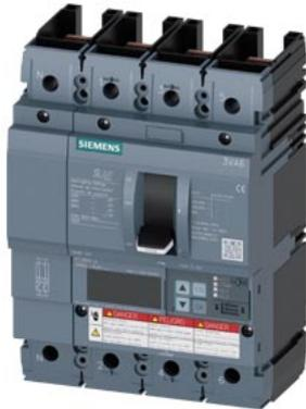
Interruttore automatico 3VA6 UL Frame 250 Classe del potere di interruzione C 100kA @ 480 V a 4 poli, protezione impianto ETU820, LI, In=100A protezione da sovraccarico Ir=40A...100A protezione da cortocircuito Ii=1,5...12 x In senza collegamento
