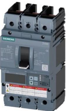
Interruttore automatico 3VA6 UL Frame 250 Classe del potere di interruzione C 100kA @ 480 V a 3 poli, protezione impianto ETU550, LSI, In=100A protezione da sovraccarico Ir=40A...100A protezione da cortocircuito I<sub>sd</sub>=0,6..10x I<sub>n</sub>, I<sub>i</sub>=1,5..12x I<sub>n</sub> protezione del conduttore di neutro opzionale con trasformatore di corrente, fino a 160% senza collegamento
