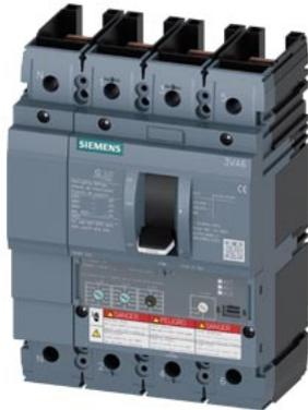
interruttore automatico 3VA6 UL frame 250 classe del potere di interruzione C 100 kA con 480V a 4 poli, protezione impianto ETU320, LI, In=100 A protezione da sovraccarico, 100 % nominale Ir=40 A ... 100 A protezione da cortocircuito li=1,5 ... 12 x In protezione del conduttore di neutro regolabile (OFF, 50 %, 100 %) senza collegamento
