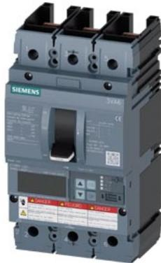
Interruttore automatico 3VA6 UL Frame 250 Classe del potere di interruzione H 65kA @ 480V a 3 poli, protezione impianto ETU860, LSIG, In=100A protezione da sovraccarico Ir=40A...100A protezione da cortocircuito I<sub>sd</sub>=0,6..10x I<sub>n</sub>, I<sub>li</sub>=1,5..12x I<sub>n</sub> protezione del conduttore di neutro opzionale con trasformatore di corrente, fino a 160% protezione da guasto verso terra I<sub>g</sub>=0,2...1 x I<sub>n</sub>, t<sub>g</sub>=0,05-0,8s senza collegamento
