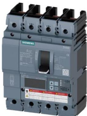
Interruttore automatico 3VA6 UL Frame 250 Classe del potere di interruzione H 65kA @ 480V a 4 poli, protezione impianto ETU830, LIG, In=100A protezione da sovraccarico Ir=40A...100A protezione da cortocircuito li=1,5...12 x In protezione da guasto verso terra Ig=0,2...1 x In, tg=0,05-0,8s senza collegamento
