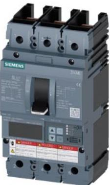
Interruttore automatico 3VA6 UL Frame 250 Classe del potere di interruzione H 65kA @ 480V a 3 poli, protezione impianto ETU556, LSI, In=100A protezione da sovraccarico Ir=40A...100A protezione da cortocircuito Isd=0,6..10x In, Ii=1,5..12x In protezione del conduttore di neutro opzionale con trasformatore di corrente, fino a 160% allarme di guasto verso terra Segnalazione tramite EFB300 o COM senza collegamento
