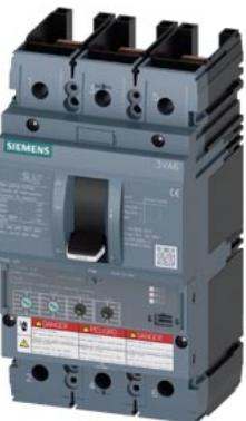
interruttore automatico 3VA6 UL frame 250 classe del potere di interruzione H 65 kA con 480V a 3 poli, protezione impianto ETU350, LSI, In=100 A protezione da sovraccarico, 100 % nominale Ir=40 A ... 100 A protezione da cortocircuito Isd=1,5 ... 10 x Ir, li=12 x In senza collegamento
