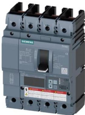
Interruttore automatico 3VA6 UL Frame 250 Classe del potere di interruzione M 35kA @ 480V a 4 poli, protezione impianto ETU850, LSI, In=100A protezione da sovraccarico Ir=40A...100A protezione da cortocircuito Isd=0,6..10x In, Ii=1,5..12x In protezione del conduttore di neutro impostabile (OFF, fino al 160%) senza collegamento
