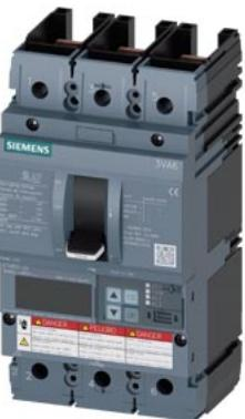
interruttore automatico 3VA6 UL frame 250 classe del potere di interruzione M 35 kA con 480V a 3 poli, protezione impianto ETU850, LSI, In=100 A protezione da sovraccarico, 100 % nominale Ir=40 A ... 100 A protezione da cortocircuito Isd=0,6 ... 10x In, li=1,5..12x In protezione del conduttore di neutro opzionale con trasformatore di corrente esterno, fino a 160 % senza collegamento
