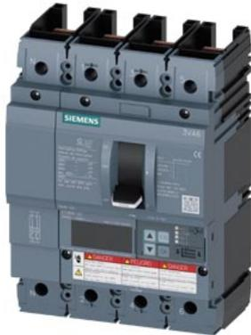
interruttore automatico 3VA6 UL frame 250 classe del potere di interruzione M 35 kA con 480V a 4 poli, protezione impianto ETU830, LIG, In=100 A protezione da sovraccarico, 100 % nominale Ir=40 A ... 100 A protezione da cortocircuito li=1,5 ... 12 x In protezione da guasto verso terra Ig=0,2 ... 1 x In, tg=0,05...0,8s senza collegamento
