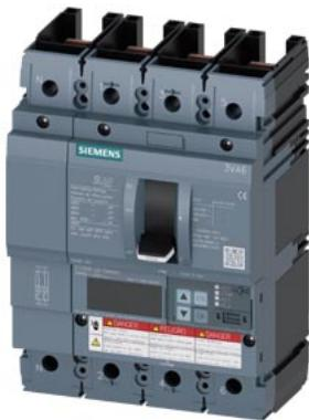
interruttore automatico 3VA6 UL frame 250 classe del potere di interruzione M 35 kA con 480V a 4 poli, protezione impianto ETU556, LSI, In=100 A protezione da sovraccarico, 100 % nominale Ir=40 A ... 100 A protezione da cortocircuito Isd=0,6 ... 10x In, li=1,5..12x In protezione del conduttore di neutro regolabile (OFF, fino al 160 %) allarme di guasto verso terra segnalazione tramite EFB300 o COM senza collegamento
