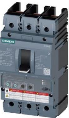
interruttore automatico 3VA6 UL frame 250 classe del potere di interruzione M 35 kA con 480V a 3 poli, protezione impianto ETU350, LSI, In=100 A protezione da sovraccarico, 100 % nominale Ir=40 A ... 100 A protezione da cortocircuito Isd=1,5 ... 10 x Ir, li=12 x In senza collegamento
