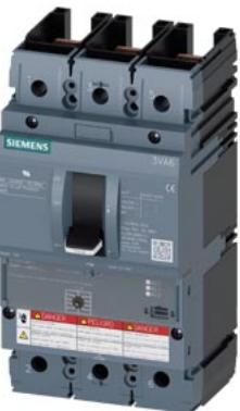
Interruttore automatico 3VA6 UL Frame 150 a 3 poli, protezione aviatore ETU310M, I, In=90A senza protezione da sovraccarico protezione da cortocircuito li=3...15 x In senza collegamento
