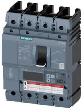
interruttore automatico 3VA6 UL frame 150 classe del potere di interruzione E 200 kA @ 480 V a 4 poli, protezione impianto ETU860, LSIG, In=60A protezione da sovraccarico Ir=24 A ... 60 A protezione da cortocircuito I<sub>sd</sub>=0,6..10x I<sub>n</sub>, I<sub>i</sub>=1,5..12x I<sub>n</sub> protezione del conduttore di neutro impostabile (OFF, fino a 100 %) protezione da guasto verso terra I<sub>g</sub>=0,4 ... 1 x I<sub>n</sub>, t<sub>g</sub>=0,05 ... 0,8 s senza collegamento
