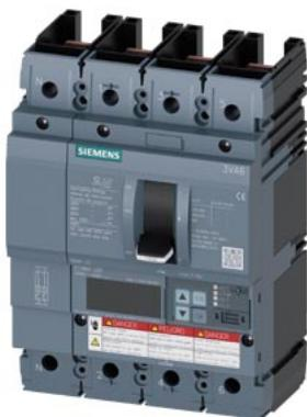
interruttore automatico 3VA6 UL frame 150 classe del potere di interruzione L 150 kA con 480 V a 4 poli, protezione impianto ETU860, LSIG, In=40 A protezione da sovraccarico, 100 % nominale Ir=16A ... 40 A protezione da cortocircuito Isd=0,6 ... 10x In, li=1,5..12x In protezione del conduttore di neutro regolabile (OFF, fino al 160 %) protezione da guasto verso terra Ig=0,375...1 x In= tg=0,05-0,8s senza collegamento
