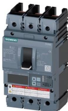
Interruttore automatico 3VA6 UL Frame 150 Classe del potere di interruzione L 150kA @ 480 V a 3 poli, protezione impianto ETU860, LSIG, In=40A protezione da sovraccarico Ir=16A...40A protezione da cortocircuito I<sub>sd</sub>=0,6..10x I<sub>n</sub>, I<sub>ii</sub>=1,5..12x I<sub>n</sub> protezione del conduttore di neutro opzionale con trasformatore di corrente, fino a 160% protezione da guasto verso terra I<sub>g</sub>=0,375...1 x I<sub>n</sub>, t<sub>g</sub>=0,05-0,8s senza collegamento
