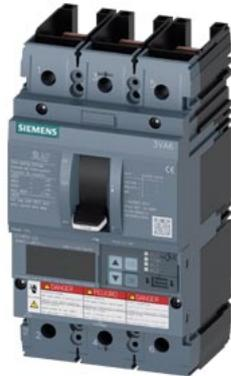
interruttore automatico 3VA6 UL frame 150 classe del potere di interruzione L 150 kA con 480 V a 3 poli, protezione impianto ETU850, LSI, In=40 A protezione da sovraccarico, 100 % nominale Ir=16A ... 40 A protezione da cortocircuito I<sub>sd</sub>=0,6 ... 10x I<sub>n</sub>, I<sub>i</sub>=1,5..12x I<sub>n</sub> protezione del conduttore di neutro opzionale con trasformatore di corrente esterno, fino a 160 % senza collegamento
