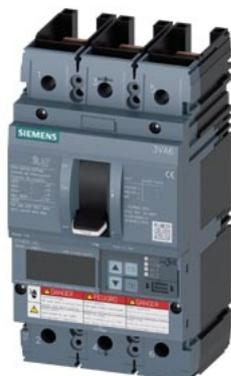
interruttore automatico 3VA6 UL frame 150 classe del potere di interruzione L 150 kA con 480 V a 3 poli, protezione impianto ETU830, LIG, In=40 A protezione da sovraccarico, 100 % nominale Ir=16A ... 40 A protezione da cortocircuito li=1,5 ... 12 x In protezione da guasto verso terra Ig=0,375...1 x In, tg=0,05...0,8s senza collegamento
