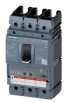
interruttore automatico 3VA6 UL frame 150 classe del potere di interruzione L 150 kA con 480 V a 3 poli, protezione impianto ETU350, LSI, In=40 A protezione da sovraccarico, 100 % nominale Ir=16A ... 40 A protezione da cortocircuito Isd=1,5 ... 10 x Ir, Ii=12 x In senza collegamento
