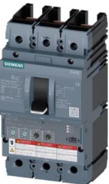
Interruttore automatico 3VA6 UL Frame 150 Classe del potere di interruzione L 150kA @ 480 V a 3 poli, protezione impianto ETU350, LSI,  $I_n=40A$  protezione da sovraccarico  $I_r=16A\dots40A$  protezione da cortocircuito  $I_{sd}=1,5\dots10 \times I_r$ ,  $I_{li}=12 \times I_n$  senza collegamento
