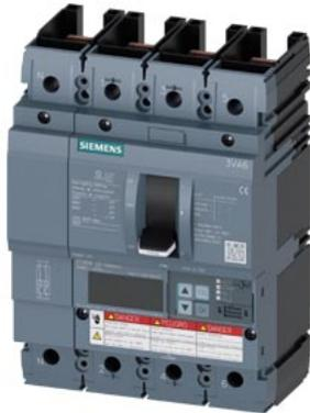
Interruttore automatico 3VA6 UL Frame 150 Classe del potere di interruzione C 100kA @ 480 V a 4 poli, protezione impianto ETU856, LSI, In=40A protezione da sovraccarico Ir=16A...40A protezione da cortocircuito I<sub>sd</sub>=0,6..10x I<sub>n</sub>, I<sub>ii</sub>=1,5..12x I<sub>n</sub> protezione del conduttore di neutro impostabile (OFF, fino al 160%) allarme di guasto verso terra Segnalazione tramite EFB300 o COM senza collegamento
