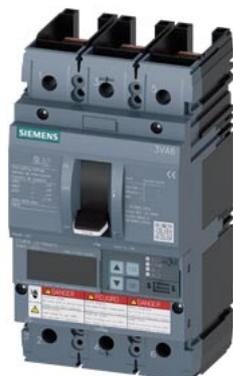
Interruttore automatico 3VA6 UL Frame 150 Classe del potere di interruzione C 100kA @ 480 V a 3 poli, protezione impianto ETU856, LSI, In=40A protezione da sovraccarico Ir=16A...40A protezione da cortocircuito I<sub>sd</sub>=0,6..10x I<sub>n</sub>, I<sub>ii</sub>=1,5..12x I<sub>n</sub> protezione del conduttore di neutro opzionale con trasformatore di corrente, fino a 160% allarme di guasto verso terra Segnalazione tramite EFB300 o COM senza collegamento
