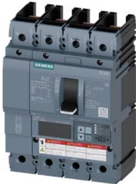
Interruttore automatico 3VA6 UL Frame 150 Classe del potere di interruzione C 100kA @ 480 V a 4 poli, protezione impianto ETU830, LIG, In=40A protezione da sovraccarico Ir=16A...40A protezione da cortocircuito I<sub>c</sub>=1,5...12 x In protezione da guasto verso terra Ig=0,375...1 x In, tg=0,05-0,8s senza collegamento
