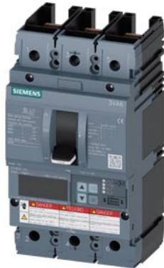
Interruttore automatico 3VA6 UL Frame 150 Classe del potere di interruzione C 100kA @ 480 V a 3 poli, protezione impianto ETU830, LIG, In=40A protezione da sovraccarico Ir=16A...40A protezione da cortocircuito Ii=1,5...12 x In protezione da guasto verso terra Ig=0,375...1 x In, tg=0,05-0,8s senza collegamento
