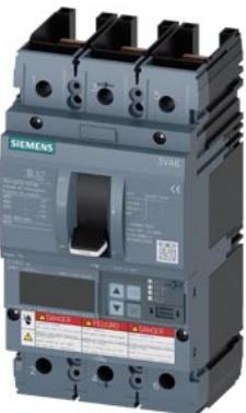
Interruttore automatico 3VA6 UL Frame 150 Classe del potere di interruzione C 100kA @ 480 V a 3 poli, protezione impianto ETU820, LI, In=40A protezione da sovraccarico Ir=16A...40A protezione da cortocircuito Ii=1,5...12 x In senza collegamento
