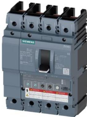
interruttore automatico 3VA6 UL frame 150 classe del potere di interruzione C 100 kA @ 480 V a 4 poli, protezione impianto ETU330, LIG,  $I_n=40$  A protezione da sovraccarico  $I_r=16A \dots 40 A$  protezione da cortocircuito  $i=1,5 \dots 12 \times I_n$  protezione del conduttore di neutro impostabile (OFF, 100%) protezione da guasto verso terra  $I_g=0,375 \dots 1 \times I_n$ ,  $t_g=0,1/0,3$  s senza collegamento
